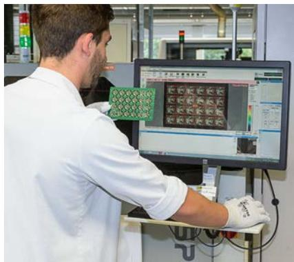
Mit Laserlicht werden die bedruckten Platinen überprüft.
