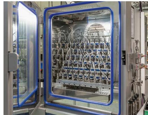
Im Klimaschrank wird die Qualität der Elektronikbauteile geprüft.
