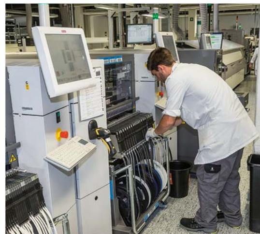
In der neuen Bestückungsanlage werden Leiterplatten automatisch und rasend schnell mit Elektronikbauteilen bestückt.
