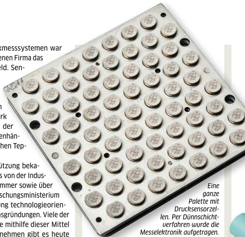
*Eine ganze Palette mit Drucksensorzellen. Per Dünnschichtverfahren wurde die Messelektronik aufgetragen.*
