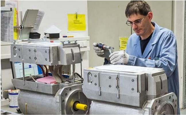
Für den elektrischen Antrieb: STW stattet Elektromotoren mit 140 kW/200 PS von Baumüller mit Leistungselektronik aus.
