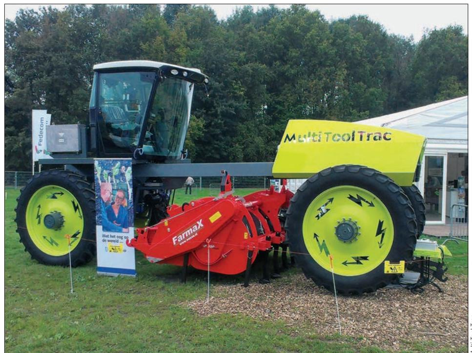
Der Multi Tool Trac hat einen Radstand von fünf Metern und einen mittleren Anbauräum für Geräte. Die Kabine kann auf dem Rahmen verschoben werden.
