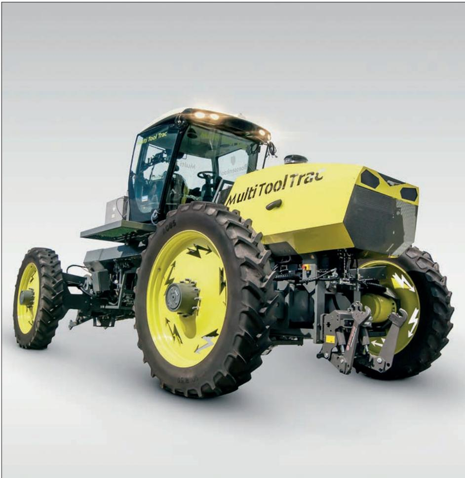
Die Spurbreite des Multi Tool Tracs lässt sich verstellen. Über GPS erfolgt die Spurführung auf dem Feld.
