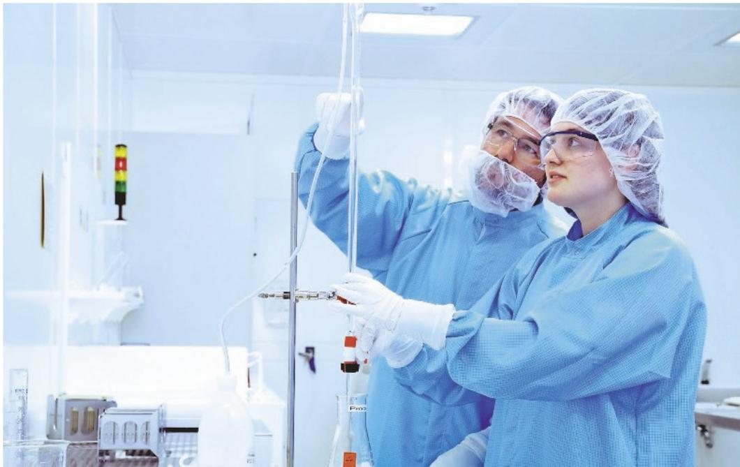
Mikrotechnologen fertigen im Reinraum in komplexen Prozessabläufen Produkte in Dünnschichttechnik. Sie stellen in unterschiedlichen Verfahren Sensoren mit Leiterbahnen und Schichten von wenigen Mikrometern Breite und Hunderten Nanometern Dicke her
