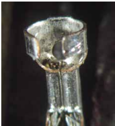
▲ Abb. 3: Trotz korrekt nach IPC ausgeführter Crimpung: Drahtbruch direkt vor der Quetschung. Die Litzenenden sind noch zu erkennen.
