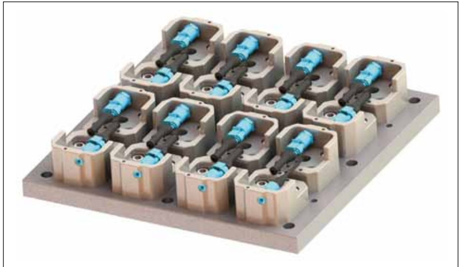
▲ Abb. 1: Das Ergebnis der FEM-Simulationen und mehrerer Entwicklungsstufen: Ein Modell des Testaufbaus mit den Prüflingen in blau.
