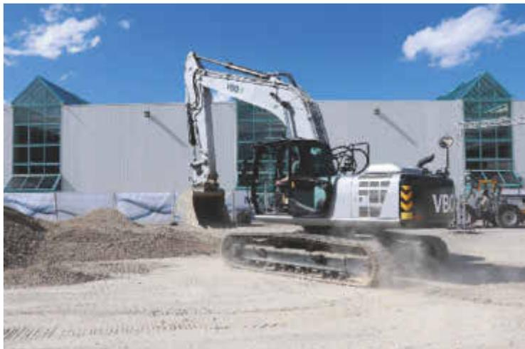
Bosch Rexroth hat sein flexibles Antriebs- und Steuerungssystem Virtual Bleed Off (VBO) weiterentwickelt
